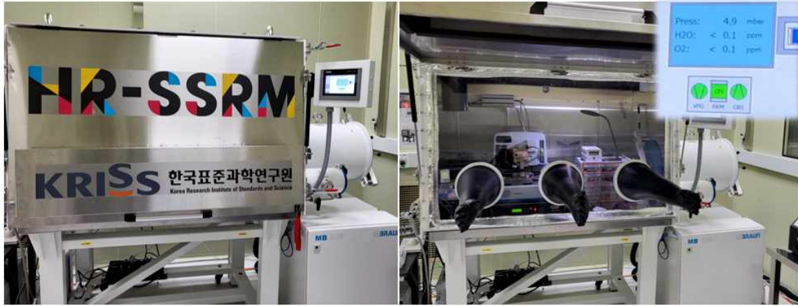
그림 14. 한국표준과학연구원에 구축된 측정범위 100 \mu\text{m} 원자힘 현미경
